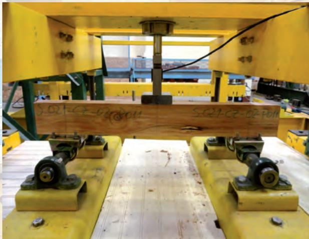
Aplicación ensayo de resistencia al cizalle paralelo a las fibras.
