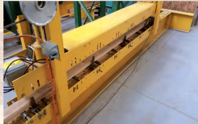
Aplicación del ensayo de resistencia a la compresión paralela.
