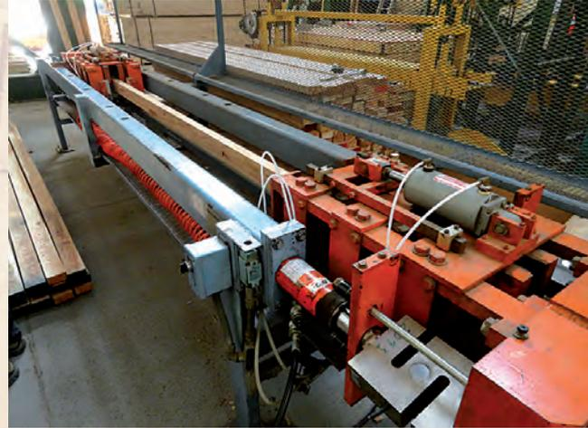
Aplicación ensayo resistencia tracción paralela a las fibras.
