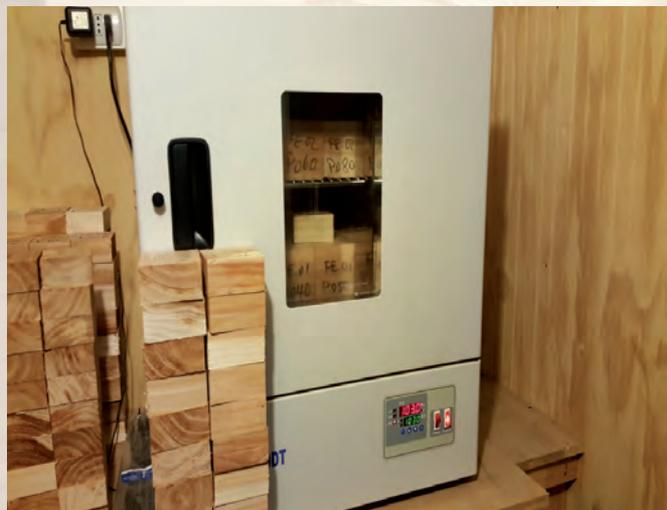
■ Aplicación del ensayo de humedad y densidad.
