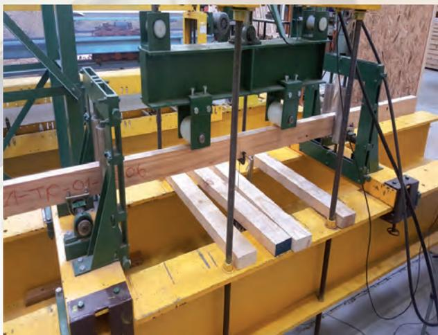
■ Aplicación del ensayo de resistencia y rigidez en flexión.
